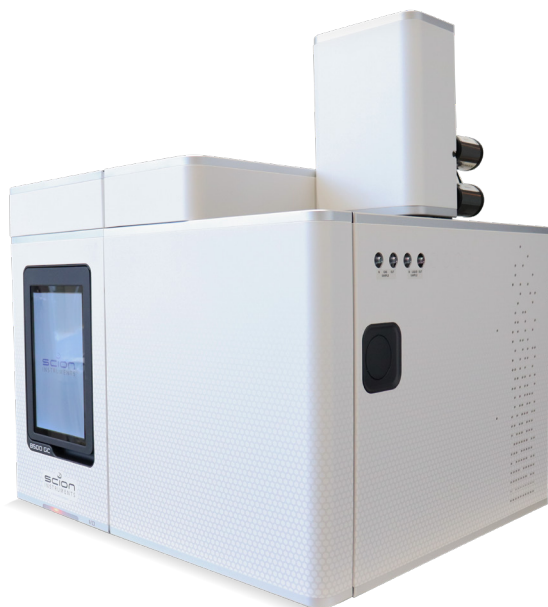
Figure 1: The SCION 8500 GC NGA Analyzer.
